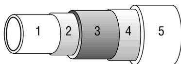
Трубы PEX- AL-PEX представляют собой пятислойную конструкцию, состоящую из наружного и внутреннего слоев полиэтилена и среднего слоя алюминия, склеенных между собой.
