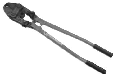
Ручной радиальный пресс для выполнения пресс-соединений пластмассовых и металлопластиковых труб. Приводной механизм с фиксатором ограничения хода.
