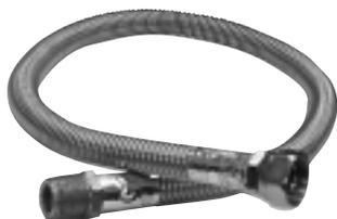
Гибкая подводка для газа из нержавеющей стали сильфонного типа. При любом скручивании не меняет внутренний диаметр, не подвергается коррозии и механическим повреждениям. Рабочая температура до 500° С.
