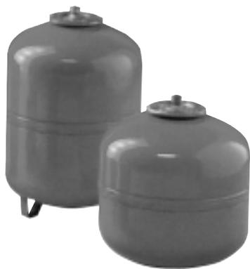
Баки предназначены для компенсации температурных расширений теплоносителя в замкнутых системах отопления. Резиновая мембрана, разделяющая водяную и воздушную полости, изготовлена из термостойкой резины. Фланец для демонтажа и замены мембраны. Предварительное давление в воздушной полости 1,5 бар. Модели до 50 литров без опор.
