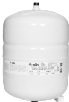
Расширительные баки с грушевидной мембраной для систем горячего водоснабжения. Максимальное рабочее давление 10 бар. Предварительное давление в воздушной полости 3 бар. Максимальная рабочая температура +99°C. Диапазон рабочих температур от -10...+110°C
