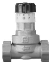
Перепускной клапан с регулируемым усилием открытия. Применяется для поддержания постоянного режима работы циркуляционного насоса в системах с термостатическими регуляторами на радиаторах.
