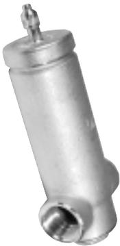
Предназначены для удаления растворенного в теплоносителе кислорода при первоначальном прогреве системы. Максимальное рабочее давление 10 бар. Максимальная рабочая температура +110°C.
