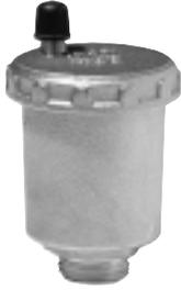
Удаляют воздух при заполнении системы. Устанавливаются в ее верхних точках. Максимальное рабочее давление 10 бар. Максимальная рабочая температура +110°C.
