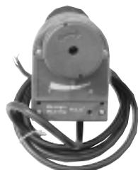
Многопозиционный привод смесителя нажимного действия, входящего в состав трубной группы котлов ACV. Монтируется при помощи переходника ASK30, входящей в комплект. 230 В, 50 Гц, 1,3 Вт. Диапазон рабочих температур 0...+50°C. Ход штока 5,5 мм. Усилие 250 Н. Время срабатывания 150 с.
