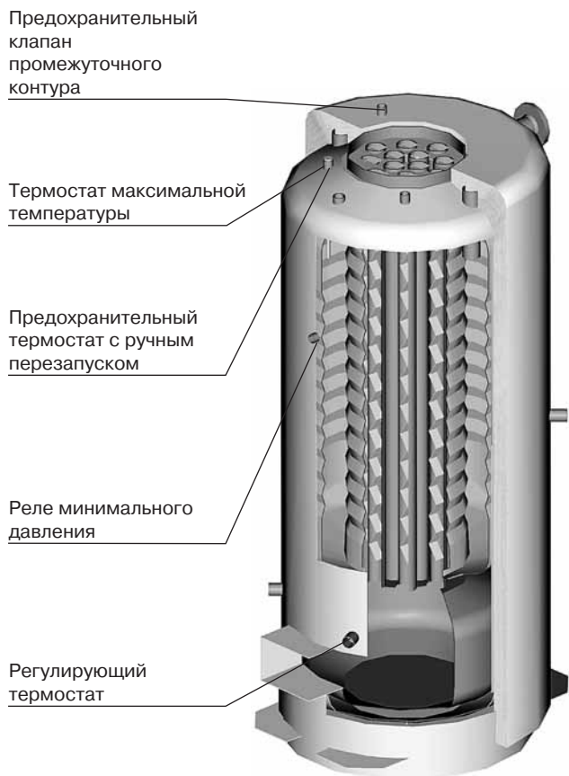
Предохранительные устройства котла Heat Master 150 Jumbo
